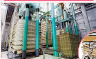
もろみを搾る「油圧搾機」。 かつては石の重みで搾っていた。
