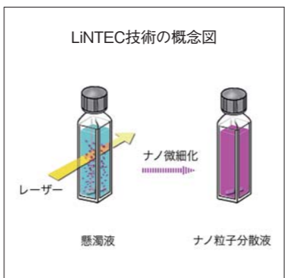
難水溶性の物質に高強度パルスレーザーを照射することで噴出したナノ粒子が、水中に物質が分散したコロロド溶液を作り出す。
